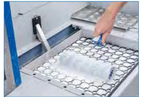
**4** Walzen-Vorwaschstation: Durch die Vorwäsche wird die Walze im TurboWash noch schneller gereinigt.
